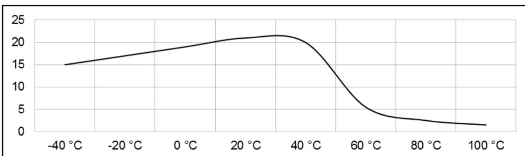
Vorbehandlung: Prüfkörper Aluminium gereinigt, geätzt. Aushärtung 4 Tage bei Raumtemperatur
