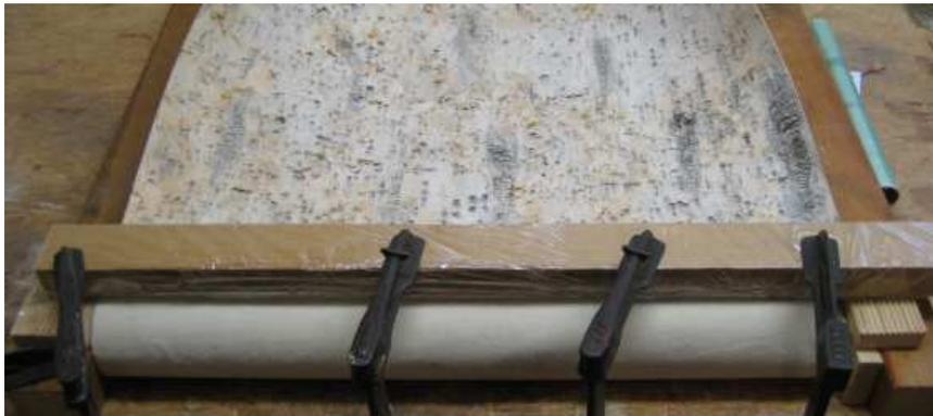
Die Trocknung sollte ebenfalls ca. 1 Tag betragen. Ich empfehle nach der Trocknung nicht die restliche Rinde in einem Rutsch auf die Schablone zu kleben sondern nur ca. 2/3. Die Handhabung den Rest zu verkleben geht damit leichter von statten.
